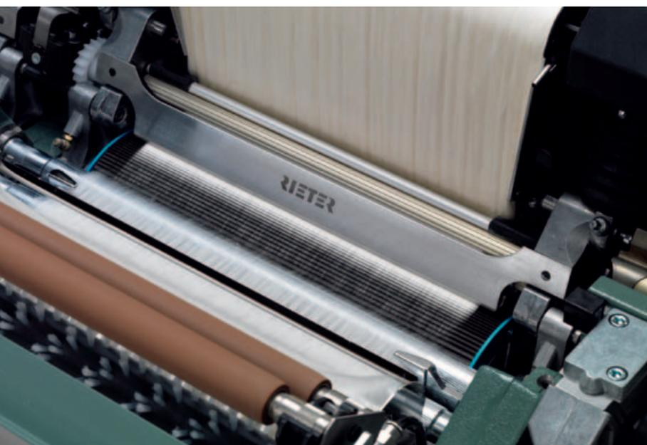
und Qualitätsverbesserung erreicht. Die Hochleistungszange, der Rundkamm und der Fixkamm – dies sind die drei wesentlichen Technologieelemente dieses Umbausatzes. Ein neuer Hauptmotor erlaubt die Steigerung der Kammspielzahlen. (Abb. 1)
