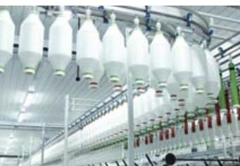
**Abb. 6** Automatischer Flyerspulentransport mit SERVOrail.
