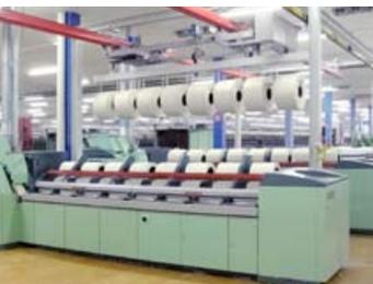
**Abb. 5** Automatischer Wickelwechsel an der Kämmmaschine mit SERVOlap E 26.
