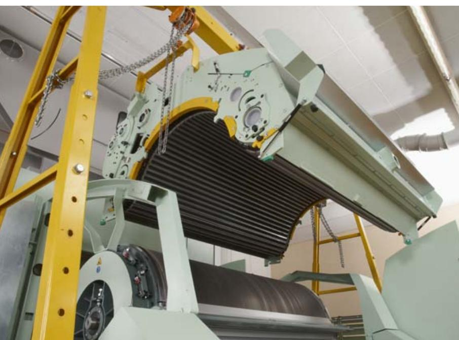
Neu kann die Deckelgeschwindigkeit über Frequenzumrichter – unabhängig von der Tambourdrehzahl – stufenlos angepasst werden. So wird die Karde individuell eingestellt – exakt auf den jeweiligen Rohstoff. Beim Vorreiser lässt sich die Auswurfdistanz variabel auf den Schmutzgehalt der Baumwolle und die gewünschte Abgangsmenge einstellen.
