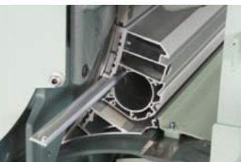
**Abb. 2** Schneller und einfacher Wechsel des Ausscheidemessers für eine variable Schmutzausscheidung.
