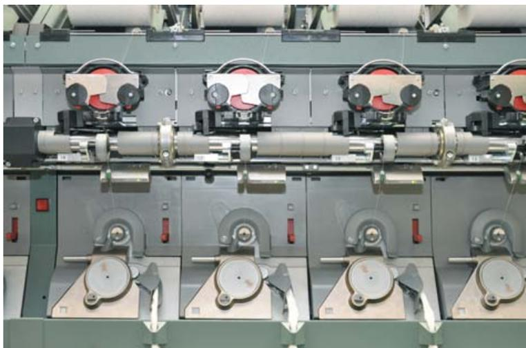
**Abb. 2** Die neue Spinnereinheit S 60 mit verbesserter Technologie ist sehr einfach bedienbar.
